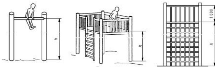
Figura 5. Esempi per la definizione dello altezza di caduta libera (fonte SFS-EN1176).
